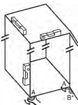
► После этого подоприте подпорками дверь: Выворачивайте регулируемую опору на опорном кронштейне (B) до тех пор, пока она не будет опираться на пол, затем крутите далее по углом 90°.
